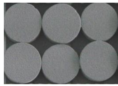
Şekil 2 . Plazma sprey kaplama işlemiyle elde edilen numuneler
